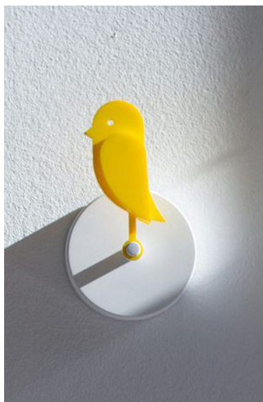
Eksempler på kommunikation af indeklimaet til inspiration: Fugl på væggen der måler indeklimaet og 'dratter' ned når kvaliteten er for lav.
