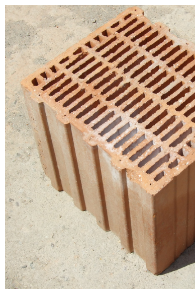
Ved at anvende en monoblok, kan flere lag erstattes af et enkelt.
